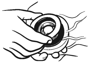
Fig. 4. Colocar la arandela de plástico
