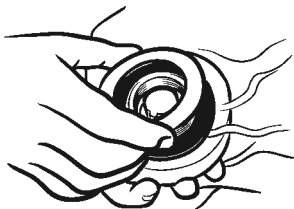
Fig. 4. Montare la rondella in plastica
