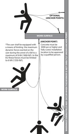
MINIMUM CLEARANCE 3ft (1m) DECK/FLOOR/GROUND LEVEL
